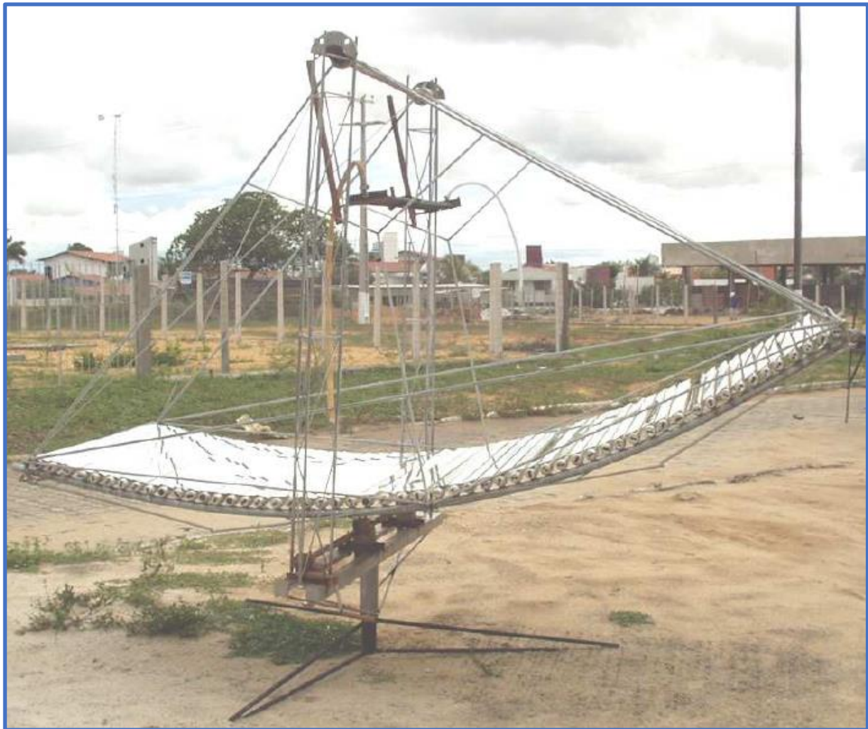
FIGURA 6: Concentrador solar projetado com mecanismo de rastreamento
