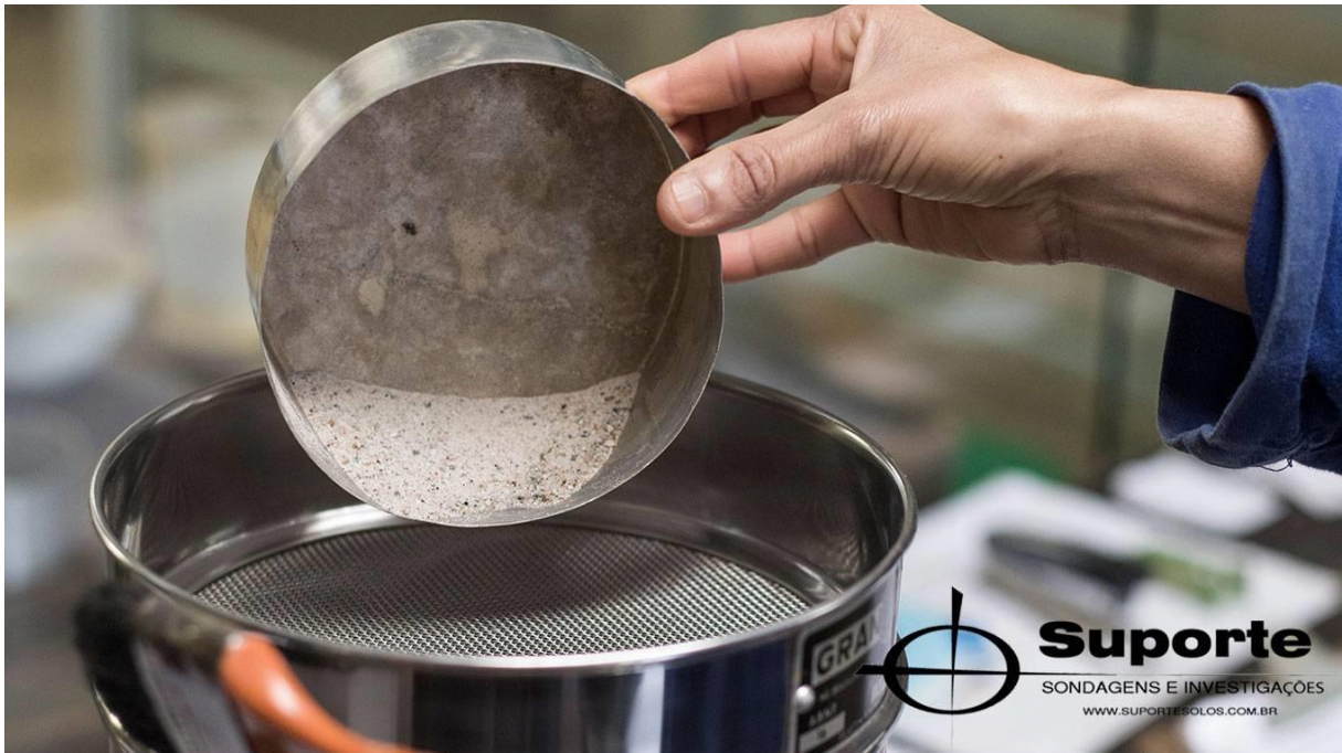
FIGURA 5 – ENSAIO DE ANÁLISE GRANULOMÉTRICA – ABNT NBR 7181 (1984)
