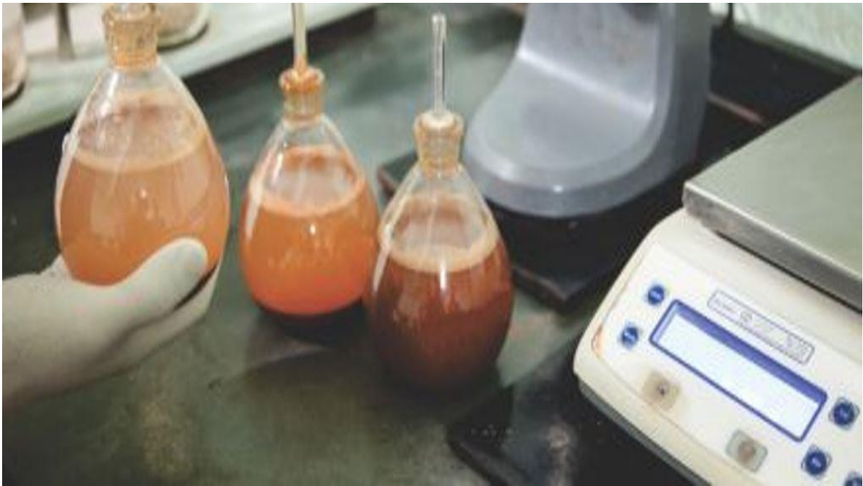
FIGURA 4 – ENSAIO DE MASSA ESPECÍFICA DOS GRÃOS – ABNT NBR 6508 (1984).
