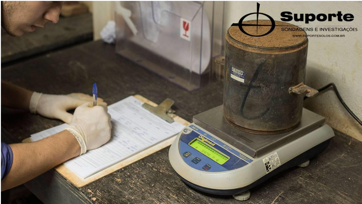
FIGURA 6 – ENSAIO DE COMPACTAÇÃO – ABNT NBR 7182 (1986)
