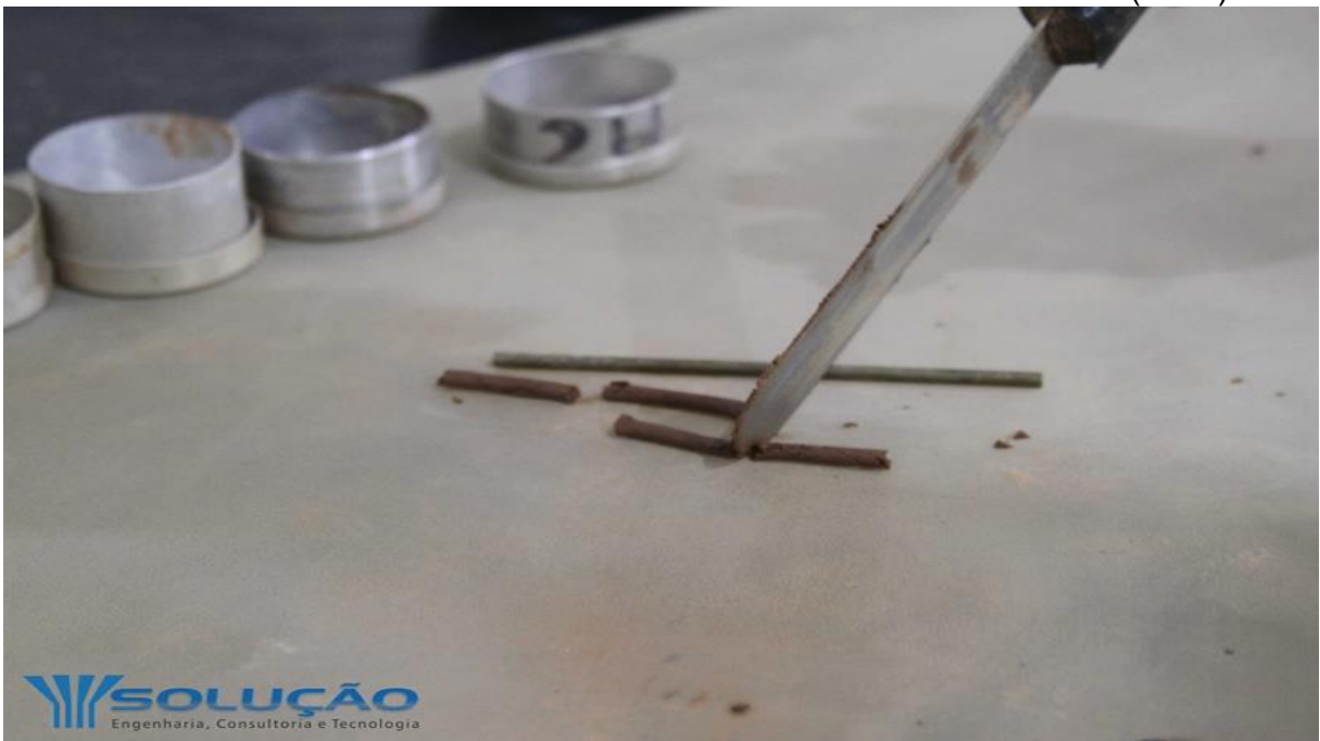
FIGURA 2- ENSAIO DE LIMITE DE PLASTICIDADE – ABNT NBR 7180 (1984)
