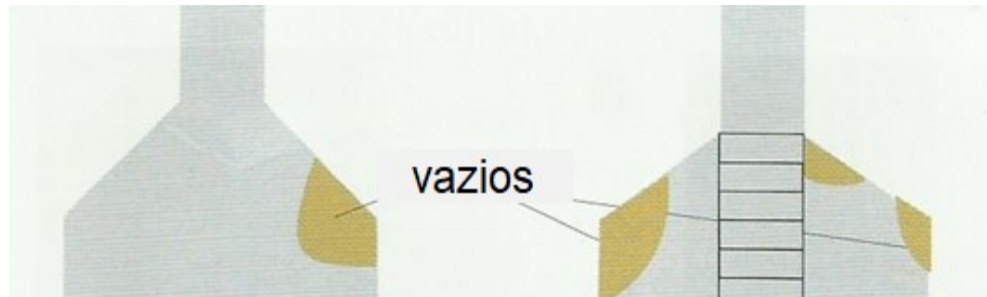
FIGURA 9 - Mau adensamento do concreto
