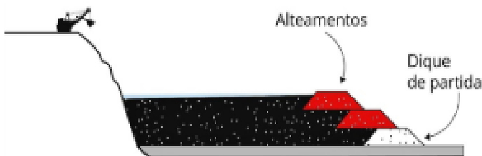
Figura 3 - Método construtivo de barragem montante (ARAÚJO,2006)
