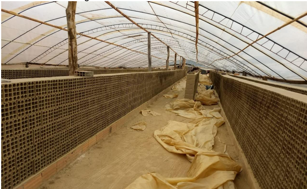
FIGURA 14 – Estufa de secagem
