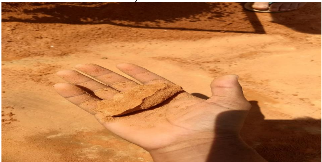
FIGURA 6 – Ponto ideal da massa de tijolo solo-cimento
