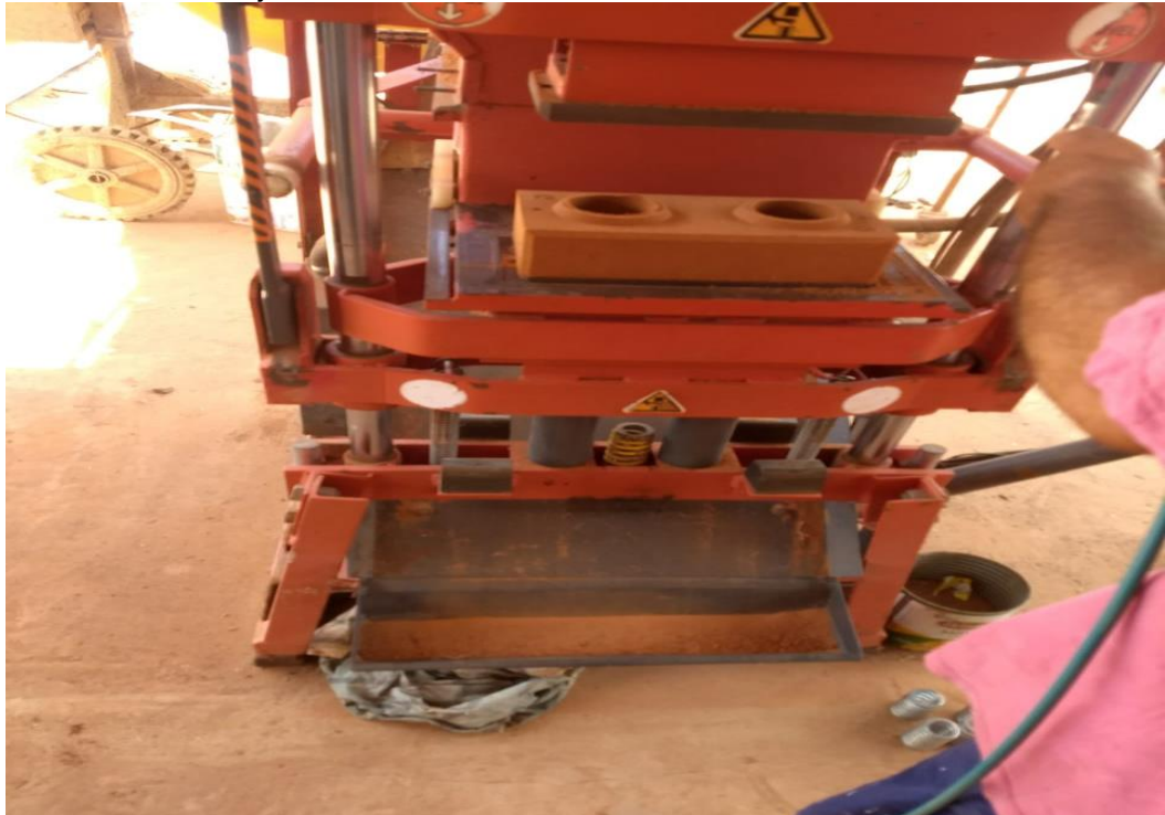
FIGURA 7 – Prensa de tijolo solo-cimento
