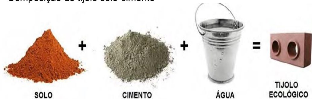
FIGURA 1 - Composição do tijolo solo-cimento
