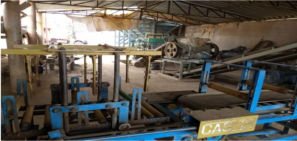
FIGURA 13: Prensa de tijolos
