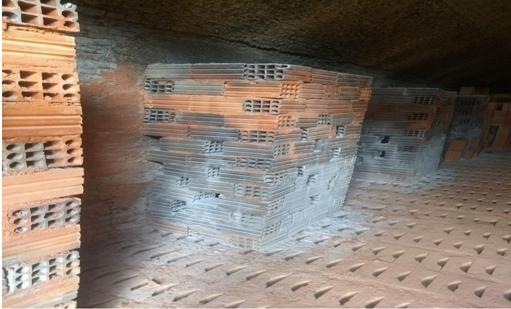
FIGURA 15 – Fornos de cozimento dos tijolos
