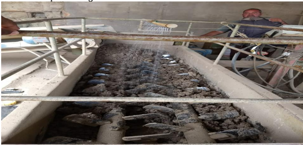
FIGURA 12 – Trituração da argila
