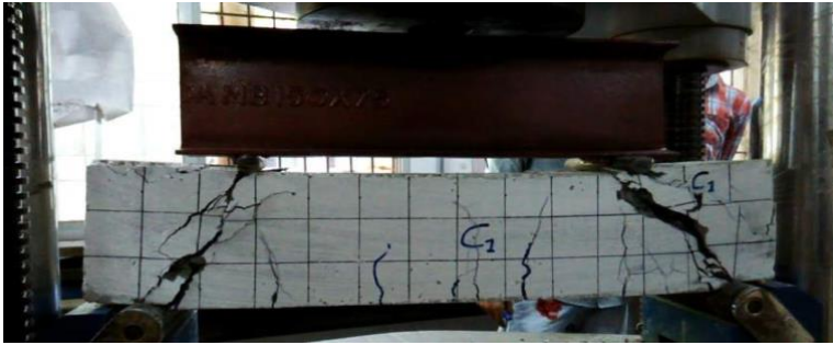
FIGURA 7 - Fissura por cisalhamento
