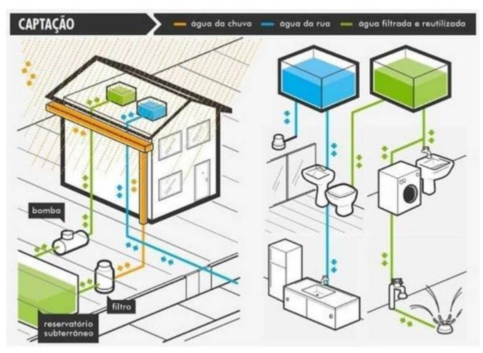
Figura 4 – Sistema de captação de água pluvial
