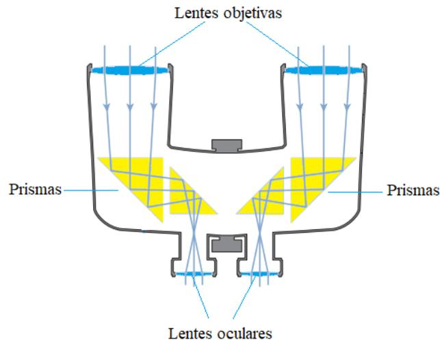
Tanto as lentes quanto os prismas são dispositivos ópticos que funcionam por refração. Sabe-se que no fenômeno da refração, dependendo do ângulo de incidência da luz sobre a superfície que separa os dois meios de propagação, a luz não atravessa a fronteira de separação destes meios, ao contrário, ela experimenta *reflexão interna total*, este ângulo é chamado de *ângulo crítico*.
